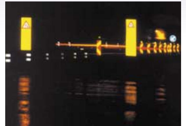
oben: Unterschied der Sichtbarkeit einer herkömmlichen Typ-I-Markierungsfolie (links) und einer Typ-II-Markierungsfolie (rechts)
