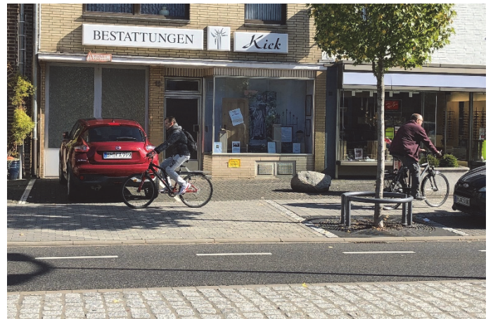
Bilder 11 und 12 | Beim Einsatz von Schutzstreifen typisch: breitere Kraftfahrzeuge nutzen den Schutzstreifen mit, Radfahrende weichen insbesondere bei schmalen Schutzstreifen zum Teil in den Seitenraum aus
