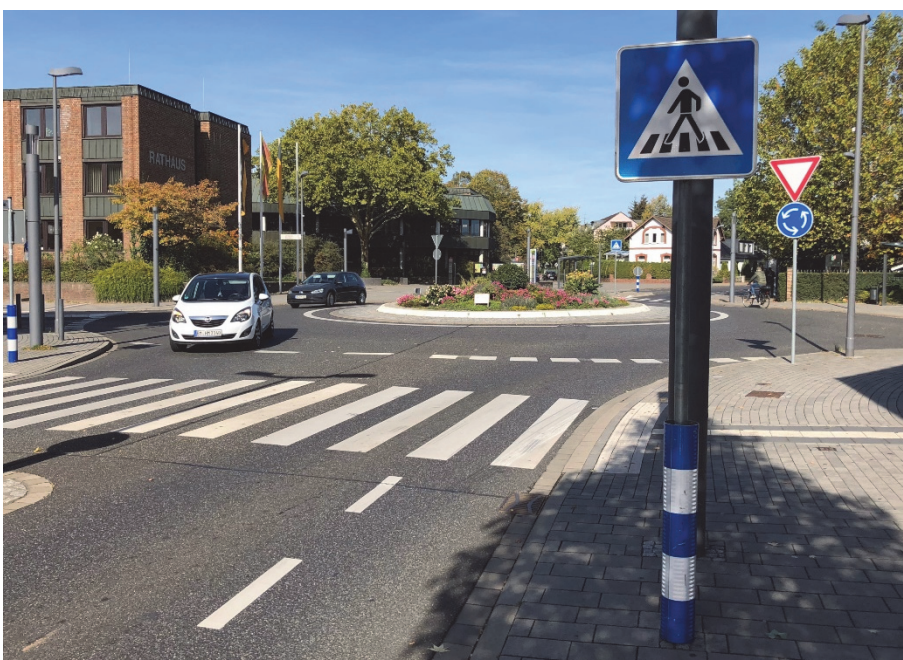
Bilder 34 und 35 | Kleiner Kreisverkehr: Sicherung des Fußverkehrs durch umlaufende Fußgängerüberwege, Führung des Radverkehrs vom Schutzstreifen in die Kreisfahrbahn, Bushaltestelle „Rathaus“ als Kap mit Wartepositionen in der nördlichen Zu- und Ausfahrt
