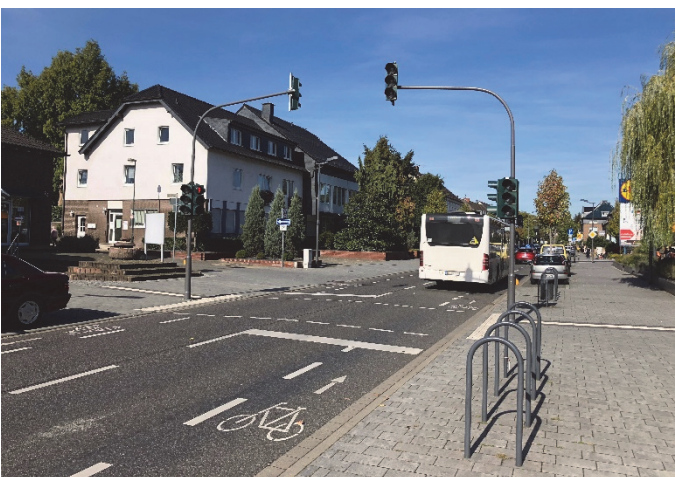
Bilder 17 und 18 | Signalisierungsform „Dunkelampel“: im Normalfall „dunkel“ für den Fahrverkehr und „Rot“ in der Furt (linkes Bild), im Bedarfsfall „Rot“ für den Fahrverkehr und „Grün“ in der Furt (rechtes Bild)
