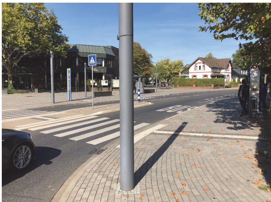
Bild 38 | Bushaltestelle: Die im Zuge der Umgestaltung an eine neue Position nördlich des Kreisverkehrs verlagerte Haltestelle „Rathaus“ ist als Kap ausgeführt – wenn der Bus in der Fahrbahn hält, müssen nachfolgende Fahrzeuge dahinter warten. Das Rathaus der Stadt Kerpen ist im Bild links hinten erkennbar.
