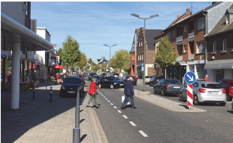
Bilder 14 und 15 | Mittelstreifen: „lineare Querungshilfe“ für Zufußgehende bei beidseitig dichtem Geschäftsbesatz, Standort für die zentral ausgerichtete Straßenbeleuchtung und überfahrbare Mitte an Grundstückszufahrten – die gewölbte Bauform fördert die Entwässerung und bietet Zufußgehenden eine weitgehende Barrierefreiheit
