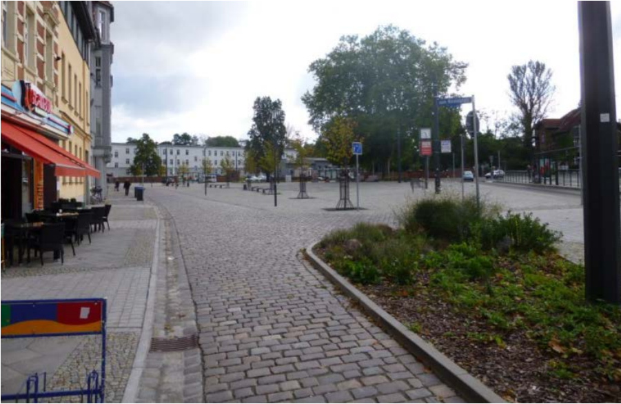
Bild 14 | Blick von Westen auf den umgestalteten Nicolaipark: hinter dem Pflanzbeet zur Häuserzeile hin abknickend verläuft die gestalterisch integrierte Fahrgasse, die zur Erschließung und Belieferung der anrainenden Grundstücke dient und als Verkehrsberuhigter Bereich ausgewiesen ist
