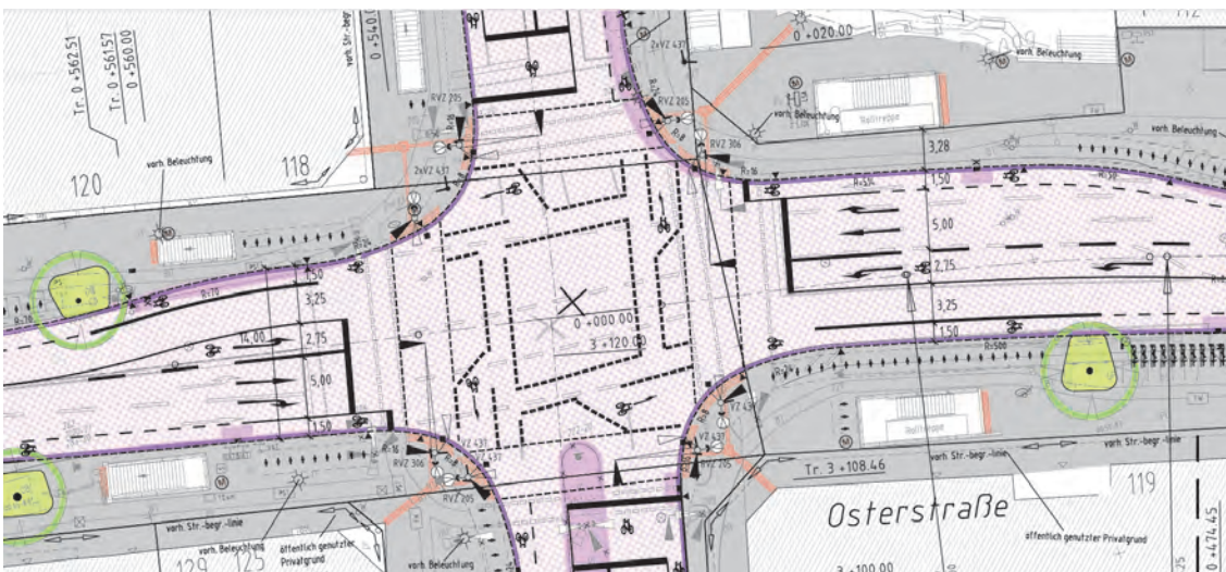
Bild 32 | Knotenpunkt Osterstraße / Heußweg: Ausbildung von vollwertigen Fahrstreifen für linksabbiegende Kfz, Mischfahrstreifen für geradeausfahrende und rechtsabbiegende Kfz, vorgezogene Haltlinie auf dem Schutzstreifen sowie für Radfahrende in der Hauptrichtung (Osterstraße) Furten, Aufstellflächen und Piktogramme zum indirekten oder direkten Linksabbiegen, im Heußweg dagegen aufgeweitete vorgezogene Warteflächen für linksabbiegende Radfahrende
