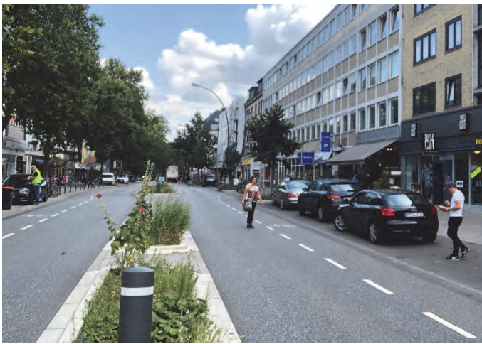
Bilder 18 und 19 | „Multifunktionsstreifen“ im südlichen Ausbaubereich: langgezogene Mittelstreifen mit barrierefreien Überquerungsflächen, links ein 2,00 m breiter Teilabschnitt mit Staudenbepflanzung, Poller und dazwischenliegenden barrierefreien Überquerungsstellen, rechts ein 2,00 m breiter Teilabschnitt ohne Einbauten
