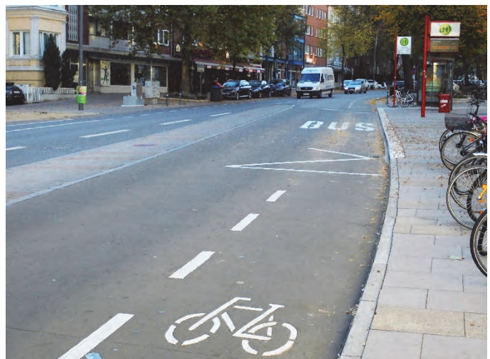
Bilder 49 und 50 | Bushaltestelle: richtliniengemäße Radverkehrsführung im Haltestellenbereich – hier Schutzstreifenmarkierung mit Unterbrechung im Bereich der Grenzmarkierung für die Busstandfläche
