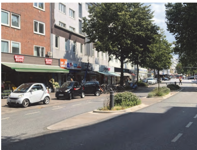
Bilder 14 und 15 | Mittelinseln im Abschnitt nördlich des Heußwegs: niveaugleich ausgebaute, schmale ellipsoide Grundform, hier links mit Mittenbaum, Pflanzbeeten und mehreren dazwischenliegenden Warteflächen für Zufußgehende, rechts als niveaugleich ausgebildete Version ohne Einbauten
