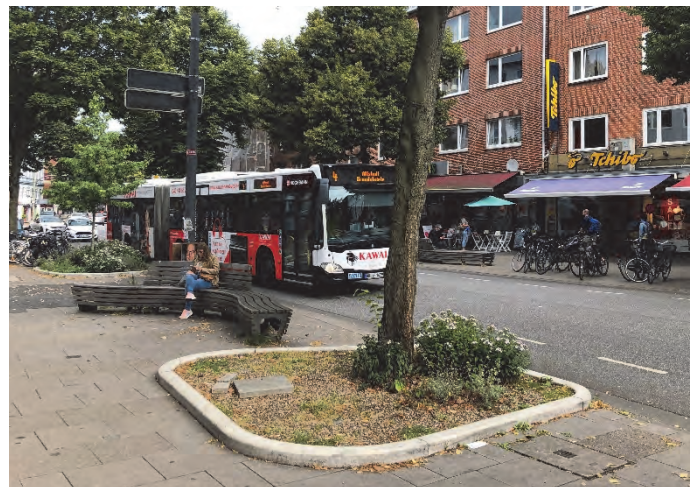
Bilder 38 und 39 | Baumbestand: großzügig dimensionierte Beete mit sparsamer Unterpflanzung schützen den Wurzelbereich und bilden durch ihre unregelmäßige, organische Grundform ein attraktives Gestaltungselement im Seitenraum
