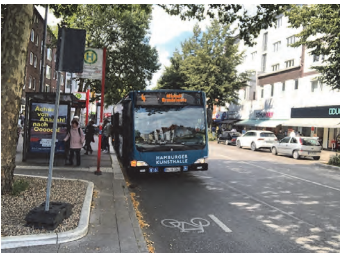
Bilder 49 und 50 | Bushaltestelle: richtliniengemäße Radverkehrsführung im Haltestellenbereich – hier Schutzstreifenmarkierung mit Unterbrechung im Bereich der Grenzmarkierung für die Busstandfläche
