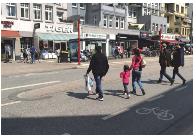
Bilder 21 und 22 | „Multifunktionsstreifen“ ohne Einbauten: im Bereich der Bushaltestelle bietet der Mittelstreifen neben der Überquerungsfunktion auch die Möglichkeit, am haltenden Bus vorbeizufahren
